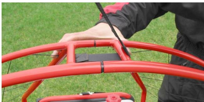
Das unterste Klettband wird durch die Schutzschiene geführt und gesichert.
