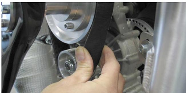
Um dem Riemen eine optimal Pflege zuteil werden zu lassen, sollte von Zeit zu Zeit das mitgelieferte Riemenpflege-spray angewendet werden. Es genügt völlig einen Hub des Aerosols auf die untere Riemenscheibe aufzusprühen.
