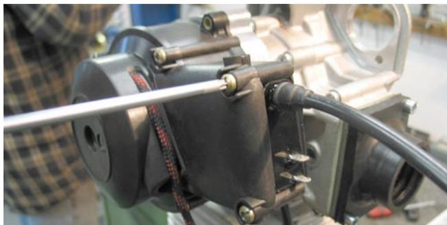
Komplettes Zündergehäuse einschließlich des Starterdeckels demontieren. Nun ist der Rotor mit dem Starterkopf sichtbar. Gehalten ist dieser mit seiner Zentralschraube.
