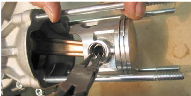
Die Einbauichtung des Kolbens ist an dem zum Auslass gerichteten Pfeil zu erkennen.
