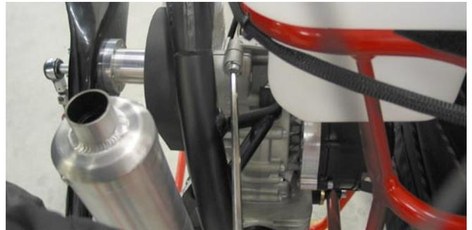
In der Propellernabe ist eine Innensechskantschraube (10mm). Diese wird entgegen dem Uhrzeigersinn verdreht bis der Riemen maximal lose ist.
