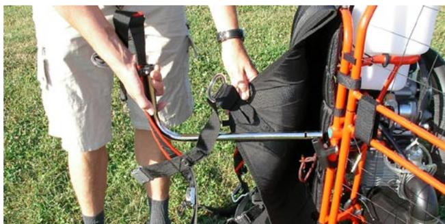
Damit die CB Stangen in der richtigen Position verbleiben, werden sie mittels diesem Bolzen gesichert.
