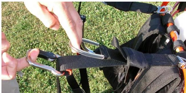
Der Gleitschirm wird in die eckigen Stahkarabiner eingehängt.
